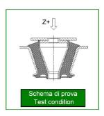
La particolare sezione sollecitata a taglio e compressione consente l'utilizzo di carichi importanti con buone deflessioni assiali. I supporti vengono montati con due rondelle di sicurezza per limitare i sovraccarichi. Sono particolarmente adatti all'utilizzo quali supporti motore e cabina.
